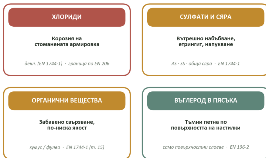
Фиг. 11 — Химичните вещества и рисковете им за бетона
