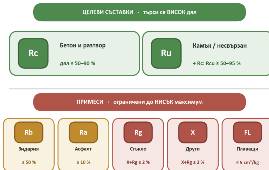
Фиг. 10 — Съставки на едрите рециклирани добавъчни материали (по EN 933-11)
