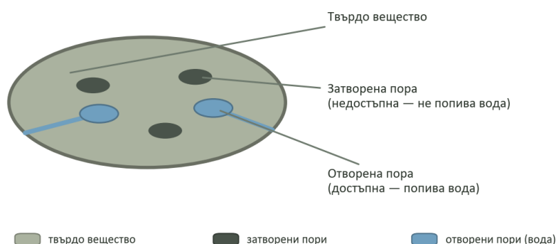
Фиг. 3 — Трите плътности на зърната (твърдо вещество и пори)
